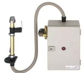
mit Tischständer und Schaltkasten mit Ein- / Austaster, Zündzeit-Einstellungsmöglichkeit und veränderbarer Sauerstoff-Nachströmzeit, für Acetylen, Propan, Methan, Mapp u.a.
