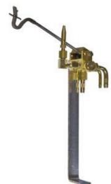
Automatische Unterbrechung der Gaszufuhr durch Einhängen des Brenners in die Gabel und automatische Freigabe der vollen Gaszufuhr bei Abnehmen des Brenners von der Gabel.
