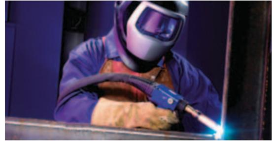
Die schraubbaren Brennerhälse sind schnell wechselbar. Sie sind in gerader oder 45° gebogener Ausführung erhältlich. Eine spezielle Schnittstelle zwischen Handgriff und Brennerhals ermöglicht das Drehen der Hälse um bis zu 360°. Alle Brenner, luft- und flüssiggekühlt für Leistungsgrößen bis 400 A, basieren auf dem bewährten „MB“-Brennerhalsaufbau.
